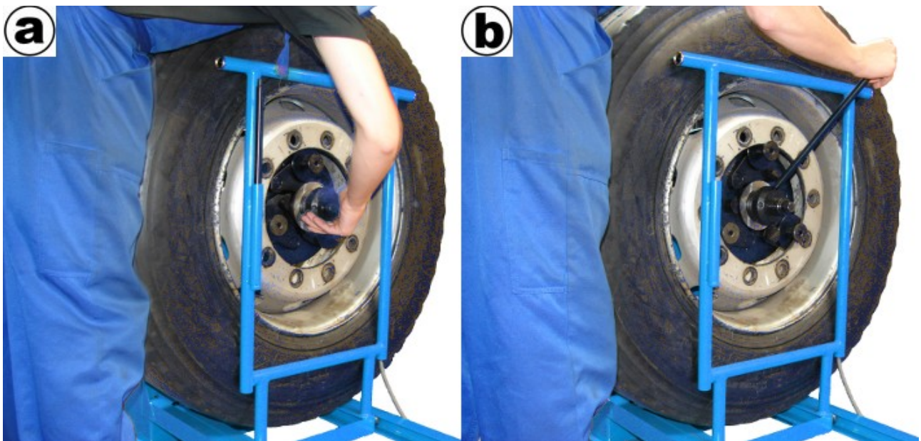
Rys. 5.14 Dokręcanie koła ciężarowego do uchwyty wyważarki.
