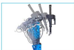
Pneumatycznie odchylenie ramię szersze u podstawy
