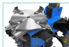
Profilowany stół montażowy od 10" do 24"
